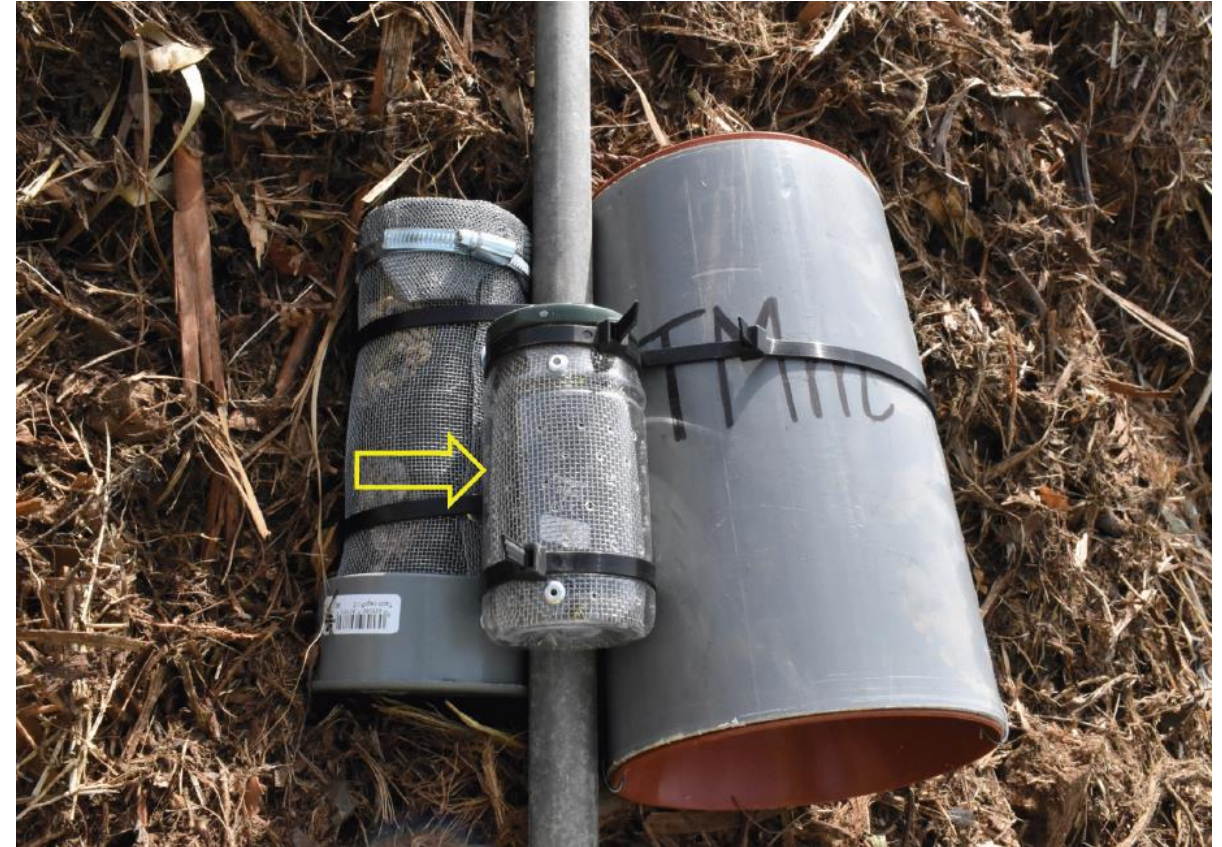
Registrador de temperatura y humedad relativa colocado, dentro de una carcasa protectora, en el túnel 3 de compostaje durante el ensayo llevado a cabo en 2019
